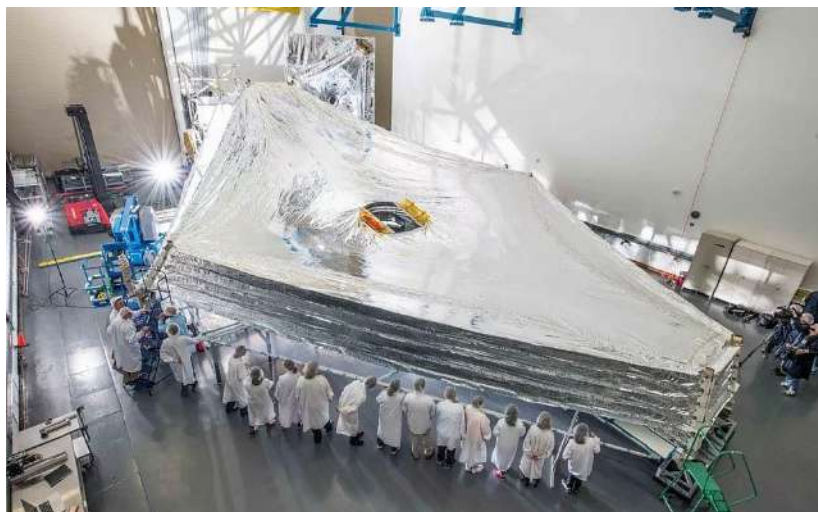
Probando el despliegue del parasol en el hangar de pruebas en la instalación Northrop Grumman en California, año 2014 195
